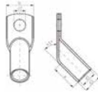
Anwendung: Für mehrdrähtige, feindrähtige, verdichtete mehr- und feindrähtige Leiter sowie für Massivleiter von 10 - 16 mm<sup>2</sup>
